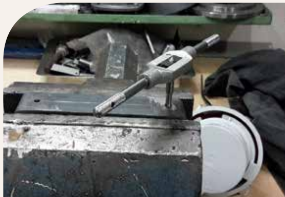
2 Gevindskæring i et beslag.
